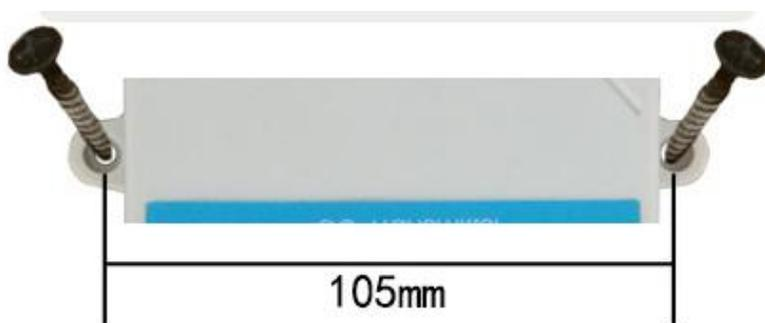
GPRS 型传感器采用壁挂式安装，安装孔位于设备两侧中部位置，安装孔径小于 4mm，孔距 105mm，可使用 3mm 的自攻螺丝安装。
